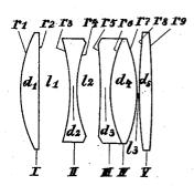
n\_D n G 42,2 d<sub>1</sub> = 7,2 I 1,6580 1,6741 51,4 65,4 12 = 11,4 42,9 d2 · 2,4 II 1,6741 1,7015 32,0 - 213,1 l<sub>2</sub> - 9,2 + 36,7 d<sub>3</sub> · 2,4 II 1,5821 1,5998 42,0 - 52,1 d<sub>4</sub> · 9,6 II 1,6580 1,6741 51,4 · + 252,5 ls · 1,1 rs - - 252,5 ds- 4,8 Y 1,6513 1,6732 38,3
